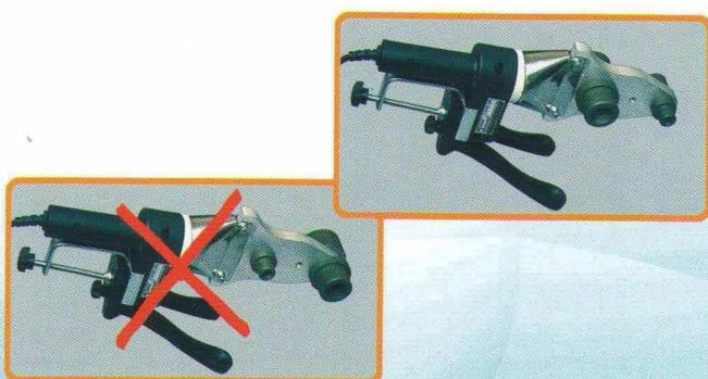
**نکته:** از بستن قالب‌های بزرگ در قسمت جلویی دستگاه خودداری کنید و قالب‌های بزرگ را همیشه در عقب ترین حفره دستگاه متصل کنید.
